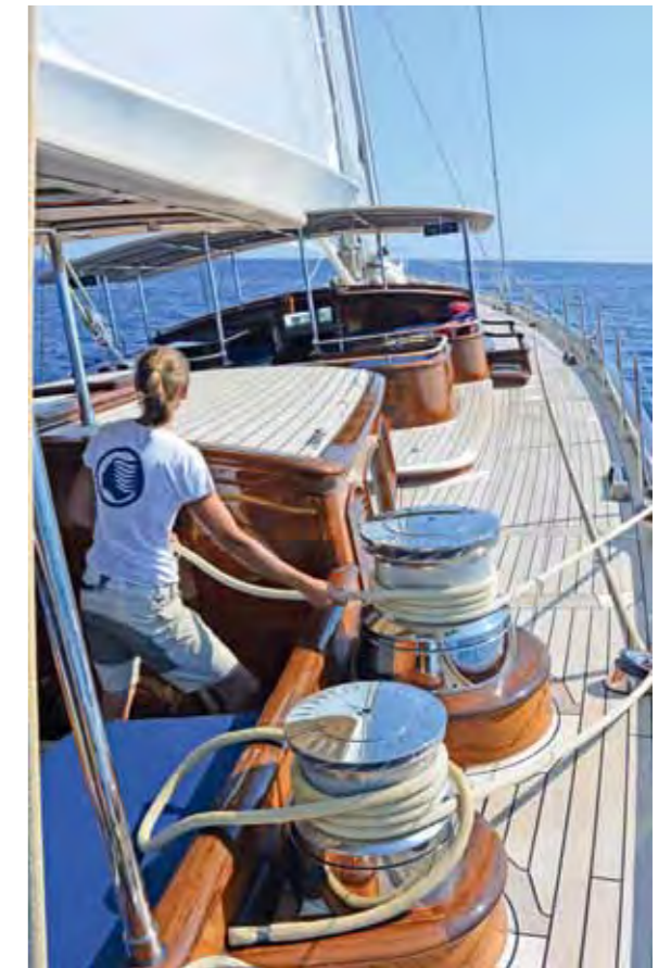
Vier Crew-Mitglieder können die 127 Fuß lange Yacht mühelos im Cruising-Modus bewegen. Bei Regatten müssten es mindestens dreimal so viele sein. Die teilweise selbstholenden Winschen sind elektrisch unterstützt.
